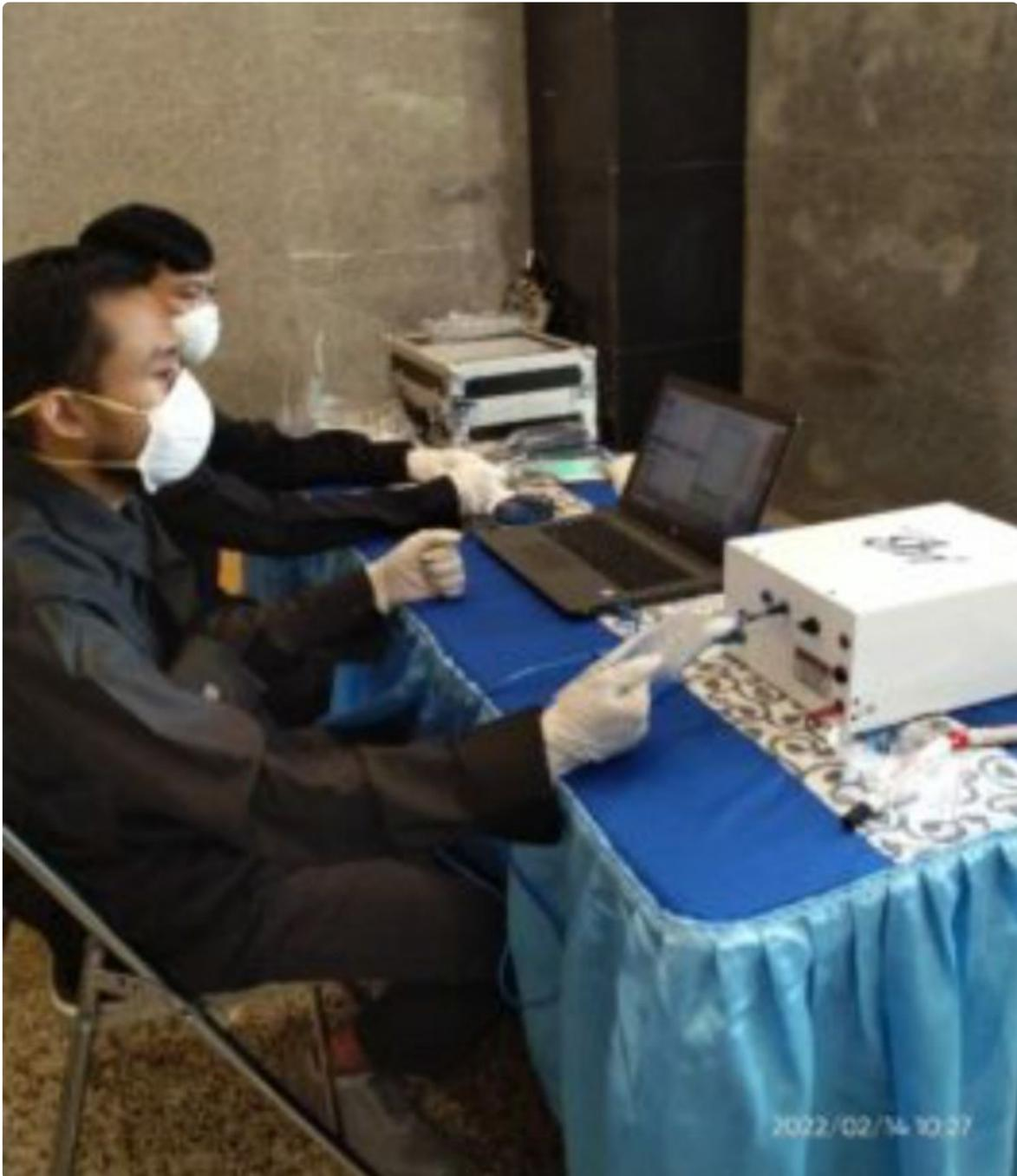
Foto : Petugas Memasukkan Plastik yang Sudah Berisikan Udara ke dalam Mesin Pendeteksi.
